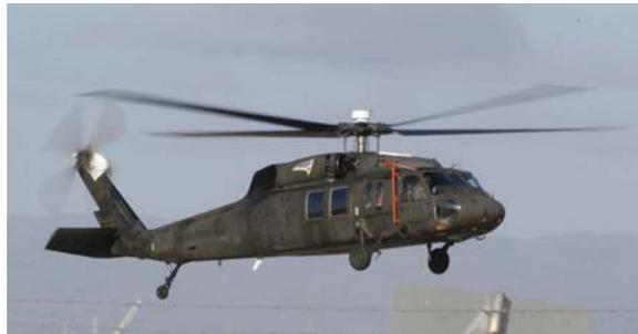
Fig. 28 AFDD RASCAL JUH-60A in-flight simulator.
